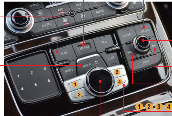
Drehregler. Zur Steuerung drehen und drücken. Rotary knob. Turn and press to control.
